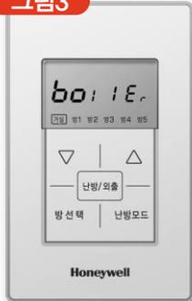
보일러에러 발생시 화면이 **그림3**와 같이 표시됩니다. 이때는 보일러 에러코드를 참조하시기 바랍니다. (보일러 에러코드를 수신하여 "boiler"와 에러 코드를 번갈아 표시)
