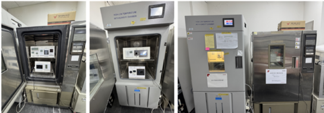
그림. 2 항온항습챔버 내부에 실내온도조절기 (DT350HF외 13종) 및 밸브제어기(MC200) 설치 및 ON-OFF 온도 측정
